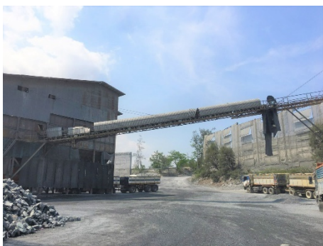
รูปที่ 2-5: การปิดคลุมสายพานลำเลียง
